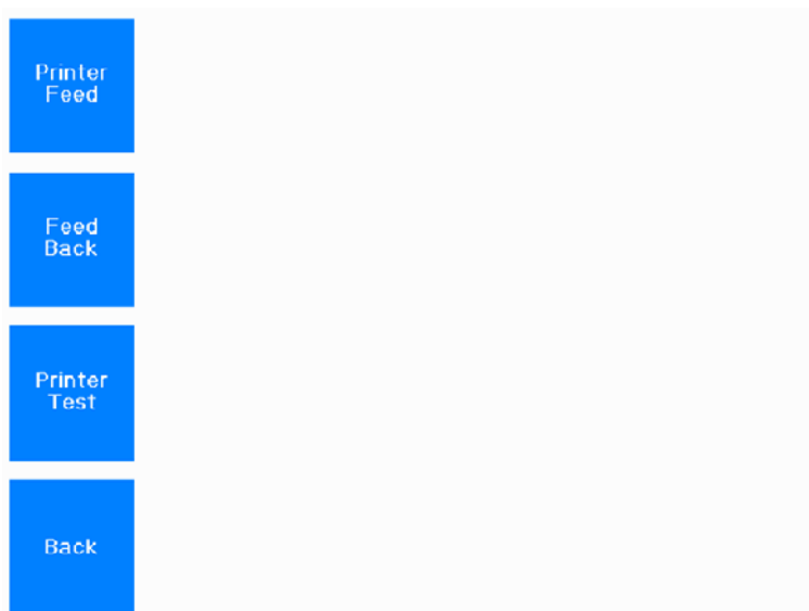
ábra 16-3: A nyomtatótekerecs előre és hátra mozgatása a kijelzővel
