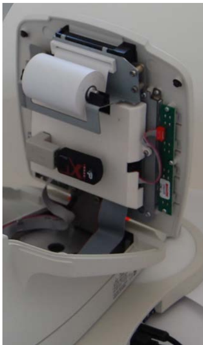
ábra 8-1: Burkolat felnyitása a kijelzővel
