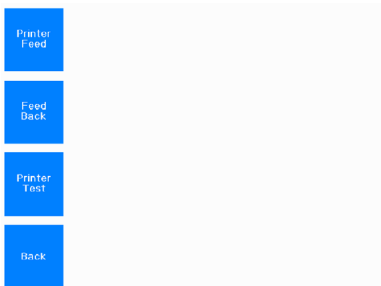
Bild 16-3: Display för att köra fram och backa skrivarrullen
