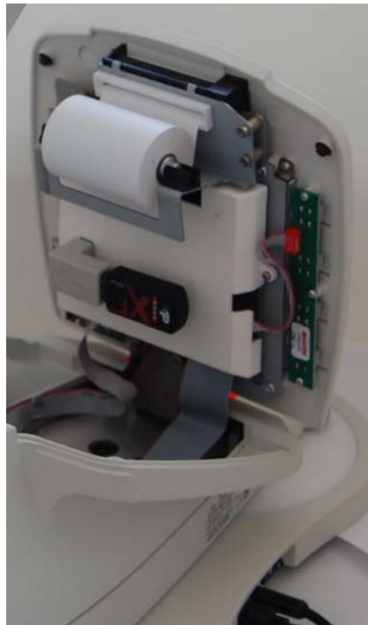
Bild 8-1: Ta av locket med displayen
