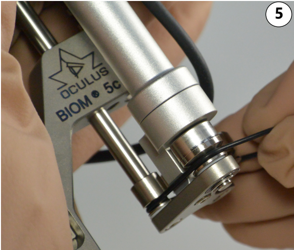
ábra 9-3: Hajtásszija és kábelvezetés felszerelése
