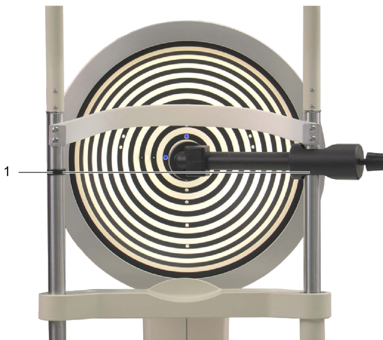
Rys. 21-5: Wyrównanie wysokości kulki referencyjnej
