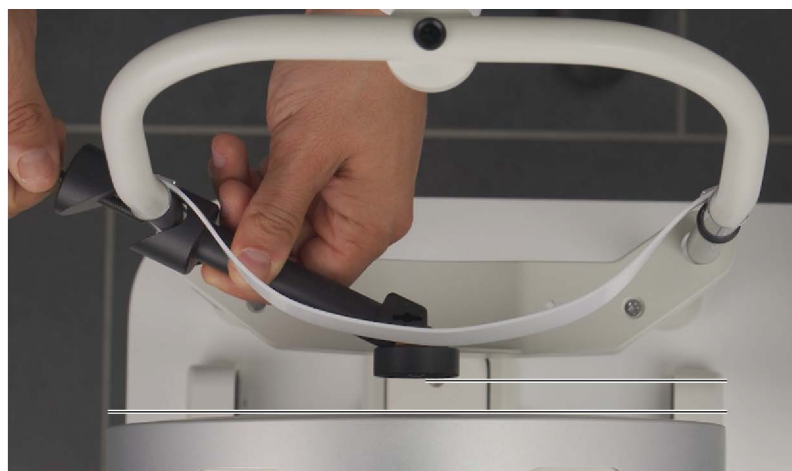
Rys. 21-4: Równoległe ustawienie kulki referencyjnej (widok urządzenia z góry)
