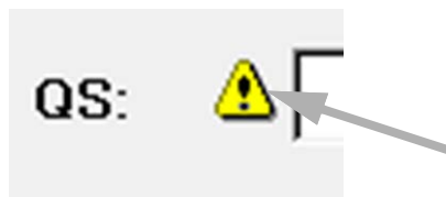
Fig.19: Hinweiszeichen, dass eine Wartung erforderlich ist
