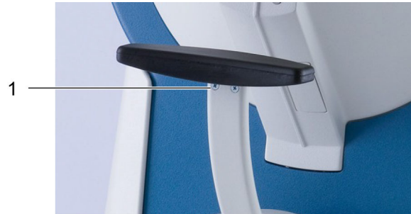
Fig. 13-2: Fixação do apoio para o queixo
